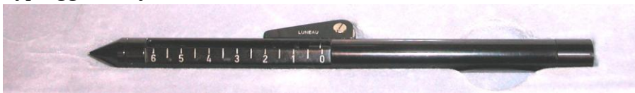
Figur 3.6 Cochet-Bonnet estesiometer for måling av
